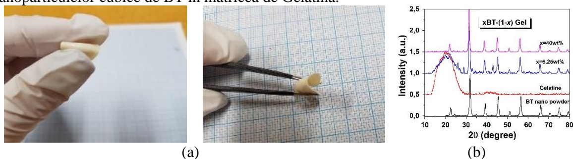
Figura 13. Filme flexibile compozite de BaTiO 3 -gelatina: (a); (b) difractogramele compozitelor xBT-(1-x)Gel.
