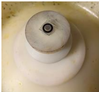
Figura 4. Fabricarea unui condensator ce contine ca dielectric SCO+PVP depus prin spin coating între electrozi ITO/Al
