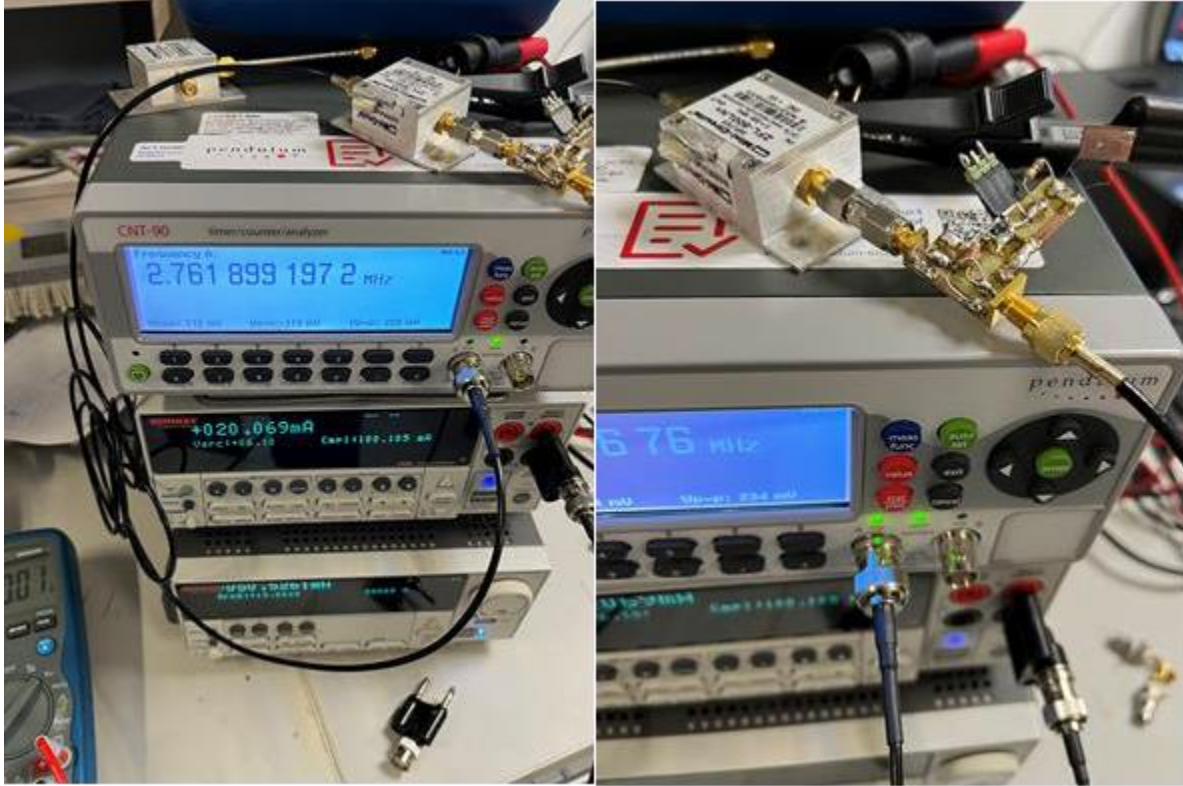
Figura 13 Stand testare circuite TDO. Contine sursa 15V amplificator, sursa variabila alimentare TDO, frecventmetru, amplificator si circuit TDO.
