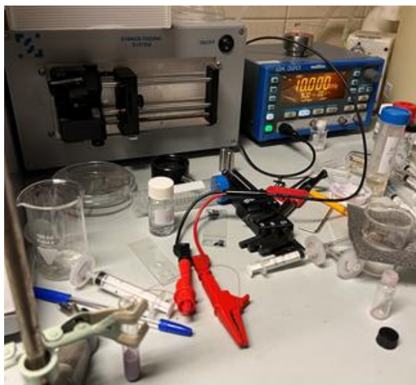
Figura 4 Setup de depunere SCO+PVP prin dielectroforeza pe o bobina dreptunghiulara Structurile astfel obținute au fost investigate cu microscopie optică și SEM.
