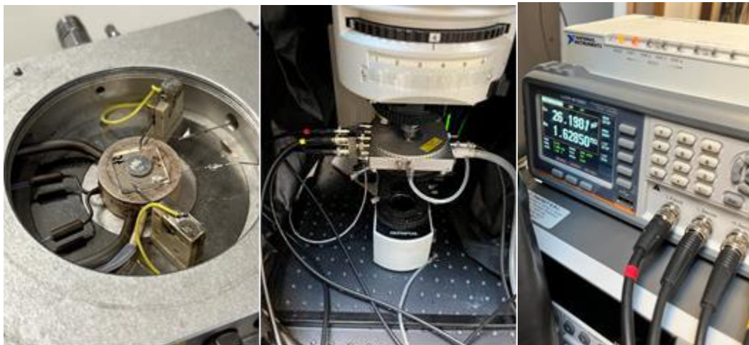
Figura 8 Testarea în temperatură variabilă, înregistrată cu LCR meter + reflectivitate a unui condensator SCO+PVP cu electrozi ITO/Al
