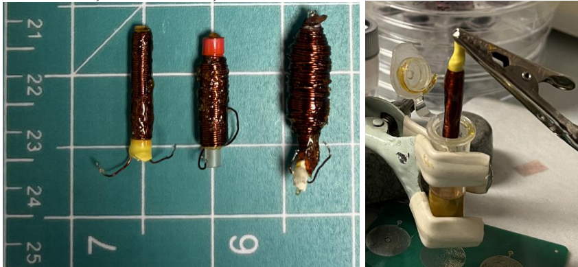
Figura 1.3. Imagini ale bobinelor de tip solenoid cu valori ale inductanței cuprinse între 5-150 \mu H, construite cu GE Varnish.
