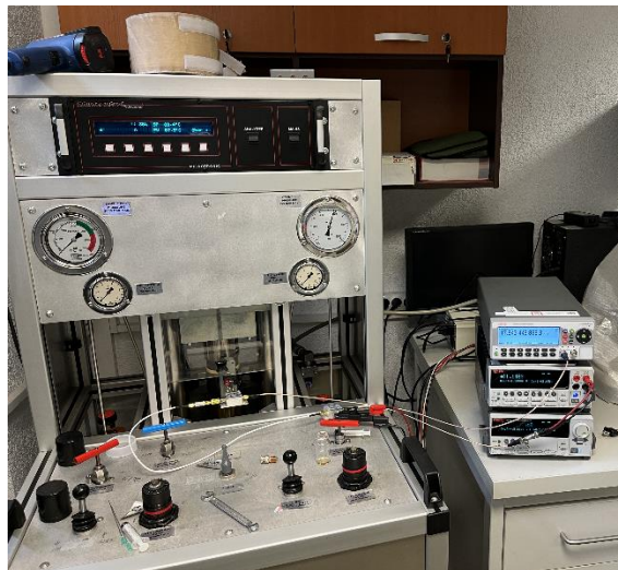
Figura 2.3. Setup TDO pe celula cu presiune variabila (0-3000bar) și temperatura variabila (300-523K) pentru măsurători de susceptibilitate cu bobina solenoid
